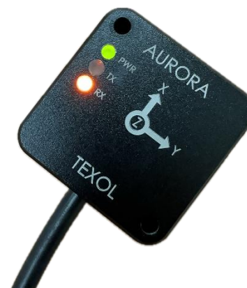
圖 2-1 213MM4-R0 工作狀態指示燈號
