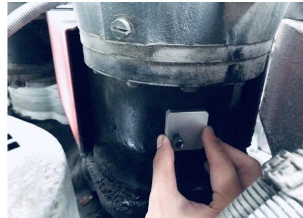
圖 3-6 固定底座於設備表面
