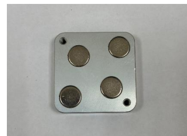
圖 1-3 智慧感測器磁座 3838M
