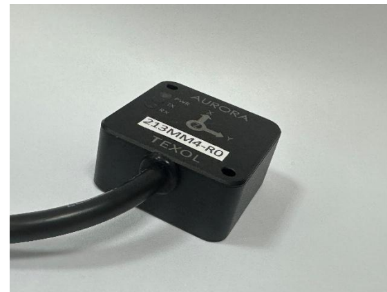
圖 1-1 213MM4-R0 有線三軸向數位多變量感測器
