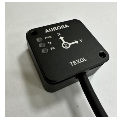
圖 1-2 213MM3-R0 有線三軸向智慧感測器
