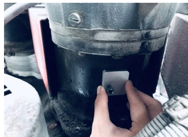
圖 3-21 固定底座於設備表面
