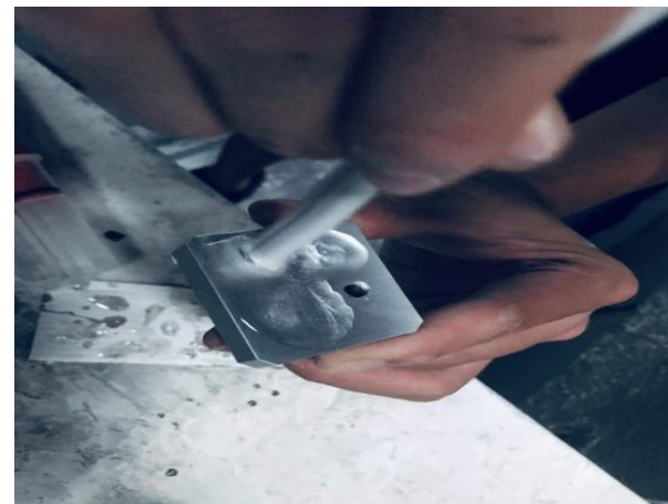
圖 3-20 塗抹 AB 膠於底座上
