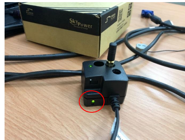
圖 3-10 藍芽智慧感測器通電時燈號
