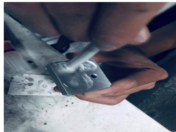
圖 3-5 塗抹 AB 膠於底座上
